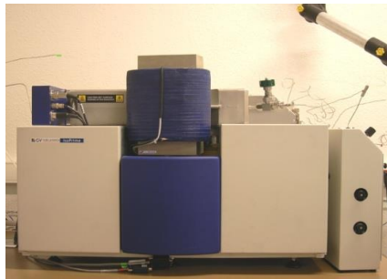
Figure C-7: Analyseur élémentaire C/N/S (EA3000, Eurovector; (A)) couplé à un spectromètre de de ratio isotopique (IRMS, Isotope Ratio Mass Spectrometer ; (B)) de marque IsoPrime (GV Instrument) utilisé pour déterminer les teneurs en N et l'abondance isotopique 15 N.
