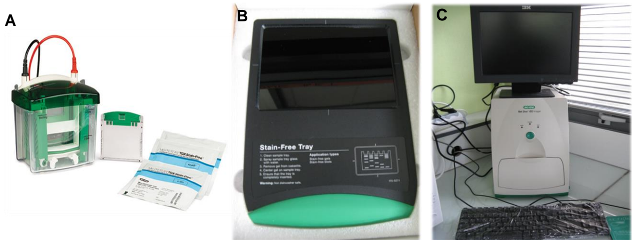
Figure C-9 : (A) Présentation du dispositif d'électrophorèse, et des gels Stain free Mini-PROTEAN® TGX™ à déposer sur la plaque de révélation (B) et à insérer au sein du scanner Gel Doc™ EZ (Bio-Rad) (C).
