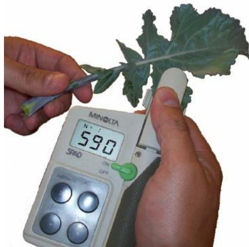
Figure 7 : Appareil permettant de mesurer la teneur relative en chlorophylles (SPAD, Soil Plant Analysis Development, Minolta, SPAD-502 model, Tokyo, Japon). Deux faisceaux (rouge et infrarouge) sont émis au niveau de la pince qui enserre le limbe. Les faisceaux traversent le tissu chlorophyllien et sont captés par la cellule réceptrice de l'appareil. L'énergie photonique est convertie en signal numérique. Le rapport entre les intensités de lumières rouges (longueur d'onde : 650 nm, partiellement absorbée par les chlorophylles) et infrarouge (longueur d'onde : supérieur à 800 nm, non absorbée) permet de déterminer la teneur relative en chlorophylles exprimées en unité arbitraire (ou unité de SPAD).
